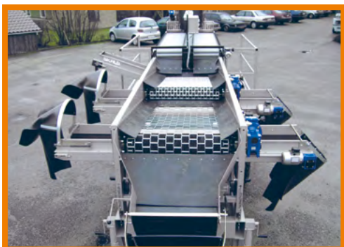
Сортировщик с ситами МОДЕЛИ: SB 902, SB 1202, SB 1502
