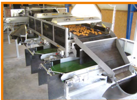
Калибровщик (динамический). МОДЕЛИ: SD 1000, SD 1400, SD 1800
