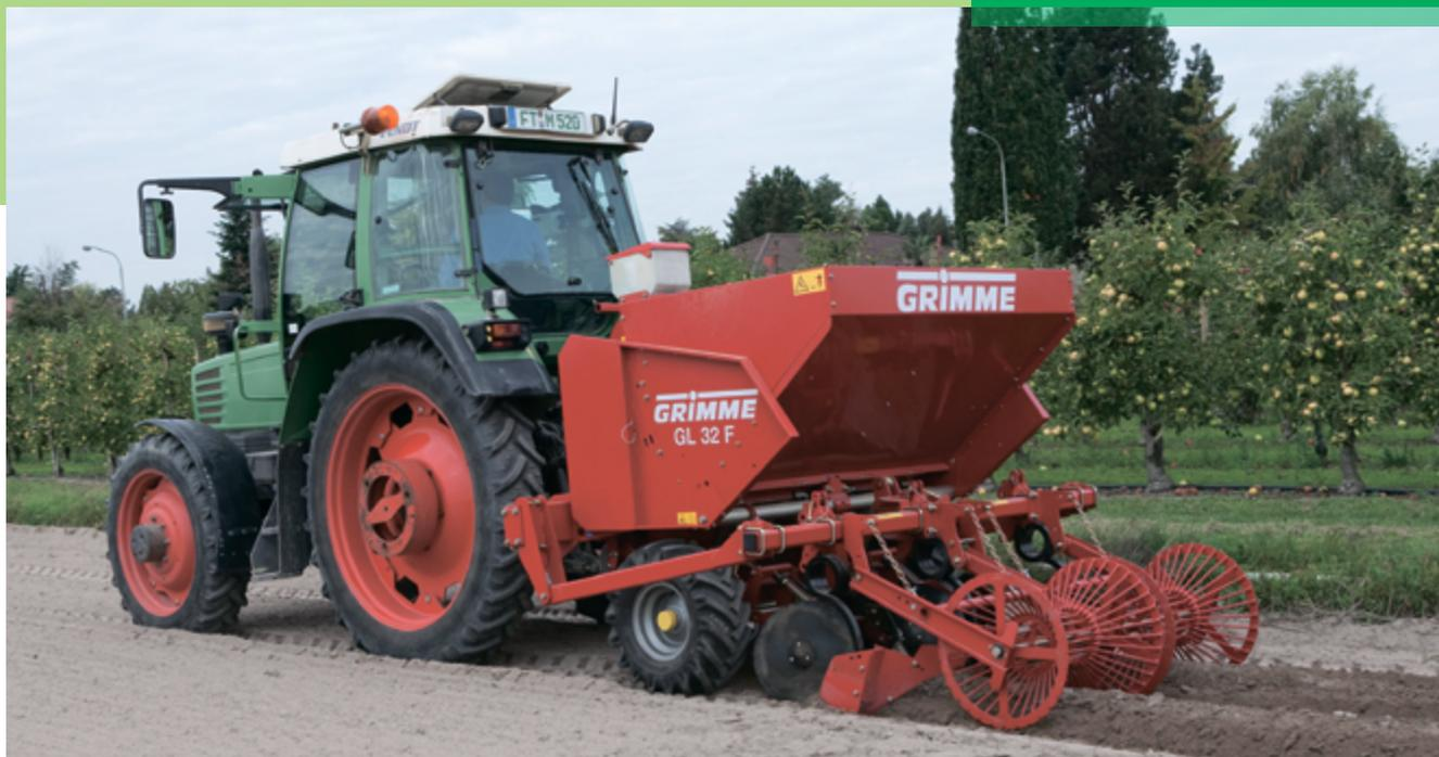
**Фото 2. Двухрядная сажалка GL 32F с высаживающим аппаратом элеваторного типа**
