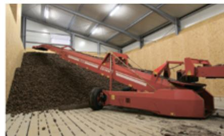
**Фото 7.** Телескопический буртоукладчик SL 80
