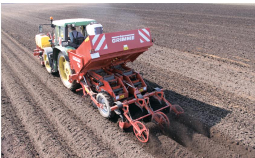
**Фото 3.** Двухрядная сажалка GL 215 с высаживающим аппаратом ременного типа
