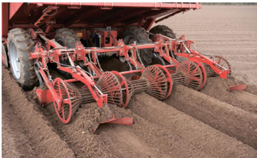
**Фото 4.** Прутковые катки в составе посадочного агрегата
