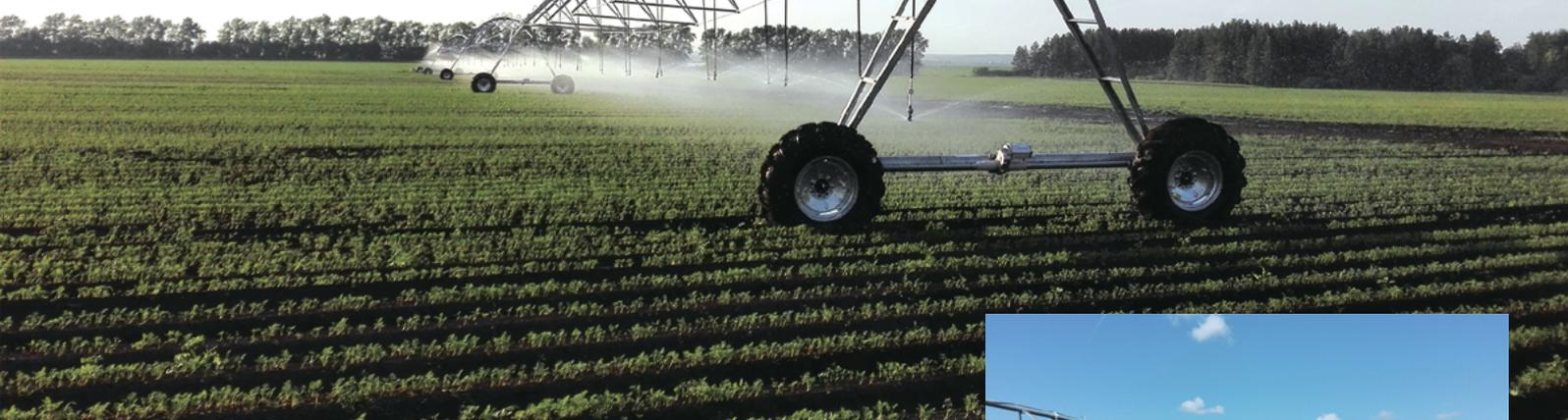
Все оросительные системы спроектированы таким образом, чтобы их можно было легко отбуксировать с поля на поле. Машины в Пое, например, в течение всего срока эксплуатации будут перемещаться вслед за картофелем. Машины подключены к системе удаленного доступа (пакет инструментов для высокоточного орошения Field Commander), что позволяет управлять каждой единицей техники через интернет-соединение (например, со смартфона).
