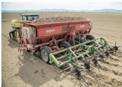
*Фото 4. Комбинированная картофелесажалка в сцепке с культиватором*
