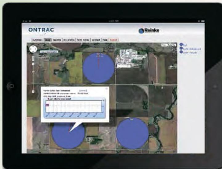
Система удаленного доступа Ontrac Радио - это радиокommunikационная система, которая транслирует из дома и офиса, это возможность оперативно получать свежие данные о статусе всех систем орошения и сохранять данные текущего сезона для последующего анализа и планирования. Наличие таких данных в несколько раз увеличивает эффективность производства.
