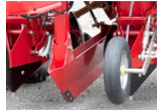
*Рис. 9. Килевидный полоз для стабилизации положения сажалки на склонах*
