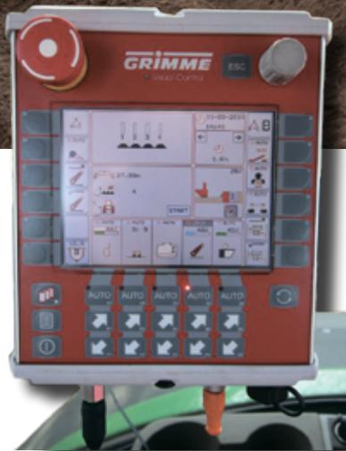
Рис. 1. Терминал VC 50
