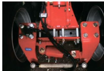
*Рис. 12. Гидравлическое управление поворотом колес*
