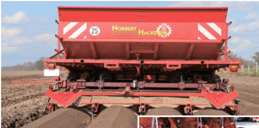
*Рис. 5. Гребнеобразователь, установленный на сажалке*
