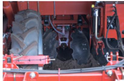
*Рис. 11. Заделывающие диски большого диаметра*
