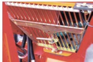
*Рис. 8. Решетки на дне высаживающего аппарата*
