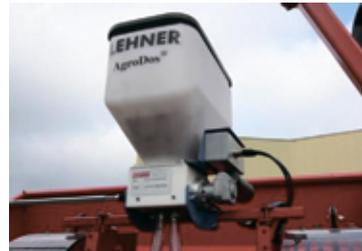
*Рис. 10. Бункер для внесения гранулированных пестицидов*
