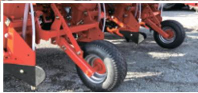
*Рис. 7. Опорное колесо для пары сошников*
