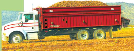
Фото 1. Кузов 4200 на шасси автомобиля
