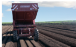
Картофелесажалка GB 330: 3-рядная посадка с междурядьем 42 см – большое количество растений на м 2 возделываемой площади по сравнению с 2-рядной грядковой технологией.
