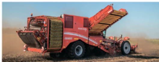
Картофелеуборочный комбайн VARITRON 470: Самоходные картофелеуборочные 2- или 4-рядные комбайны бункерного или элеваторного типа
