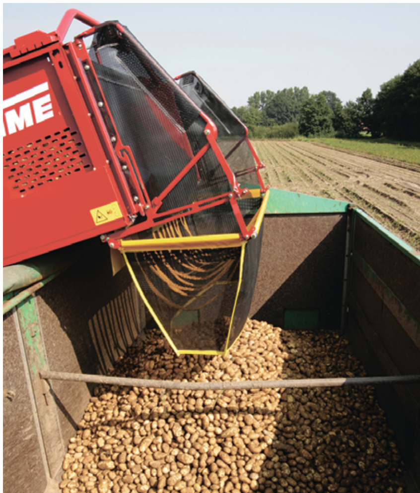
Фото 3. Гасители падения при загрузке транспортных средств
