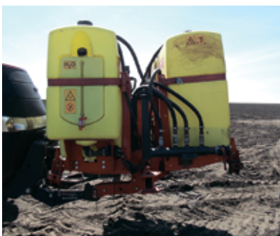
Рисунок 4. Емкость для минеральных удобрений на фронтальной навеске трактора
