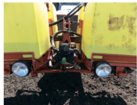
Рисунок 6. Насос с гидроприводом на раме с емкостями для удобрений
