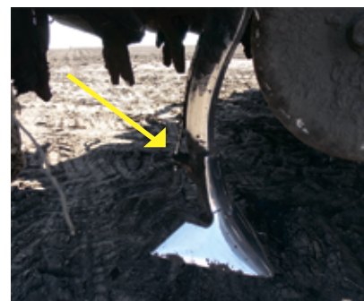
Рисунок 3. Передняя рыхлительная лапа с трубкой для внесения жидких минеральных удобрений
