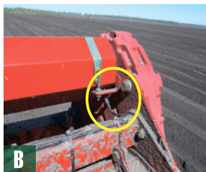
Рисунок 2. Датчики системы срабатывания предохранительных муфт: А – на центральном редукторе, В – на боковом редукторе
