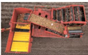
Большой интерес аудитории шоу вызвал и двухрядный картофелеборочный комбайн SE 260, который можно оборудовать не только стандартным бункером емкостью 6 т, но и заявленным на патент перегрузочным 5,5-тонным. Особенностью бункера является реверсивный и сплошной донный транспортер, который позволяет постоянно использовать максимальную емкость 5,5 т.
