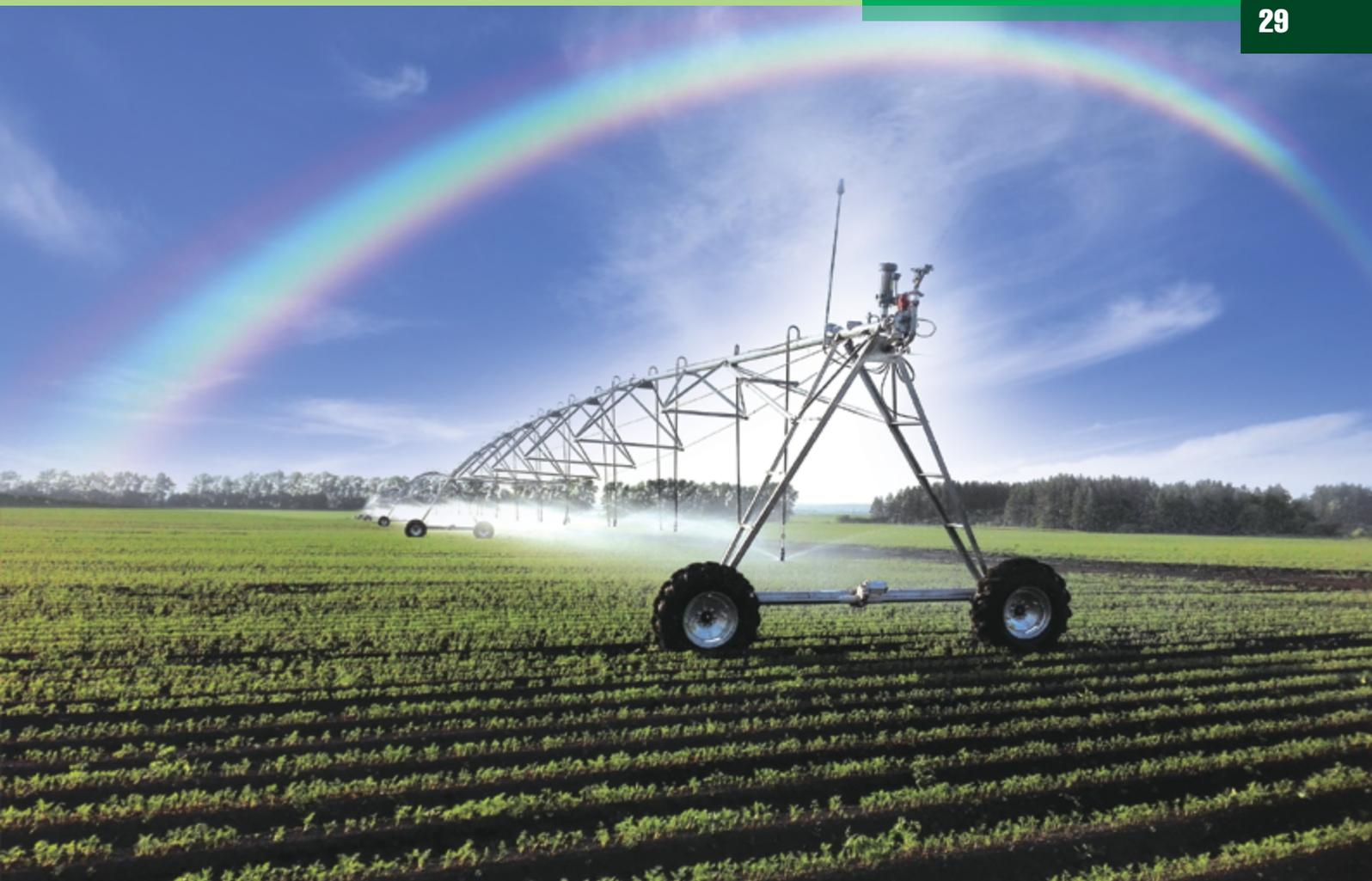
Фронтальные и круговые машины максимально эффективны на больших площадях (от 78 га), способны работать на склонах до 15%, имеют сравнительно низкие требования к давлению воды в системе (2,5-3,0 атм на входе), могут использоваться для внесения удобрений и средств защиты растений.
