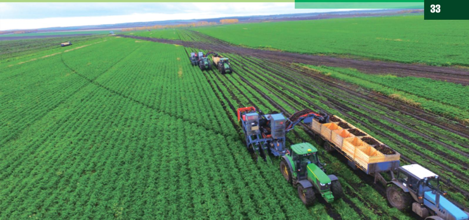
В зависимости от требований заказчика варьируются длина теребильной секции, ширина, шаг и длина транспортера, конструкция и размер бункера или элеватора и многое другое.
