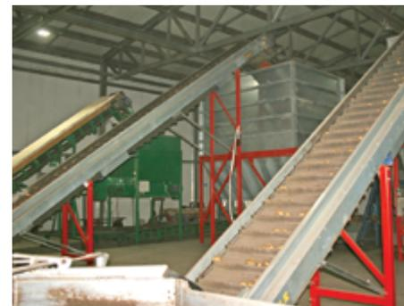
часть картофеля системой конвейеров (транспортеров) подается в хранилище, где размещается буртоукладчик. На транспортерах вручную отбирают нестандартные клубни, комки, камни и прочие примеси. Заложенный по этой технологии семенной картофель хранят до весны, а на фракции калибруют при предпосадочной подготовке.
