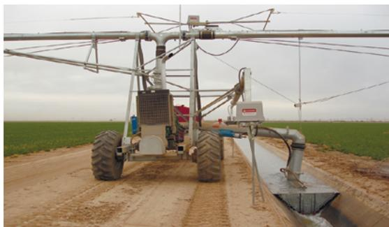
Фронтальная дождевальная машина Valley. Водозаборное устройство движется по дну канала на колесах.
