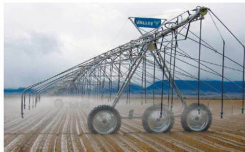
Система Boom back позволяет снизить интенсивность вылива воды, уменьшает степень размыва почвы и колеи от машины.
